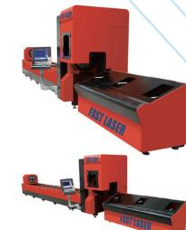
FAST光纤系列激光切割机，机身采用高强度钢整体焊接，航空铝横梁，高温退火，进口数控龙门铣 精密加工，正常使用20年不变形。采用进口伺服电机、配合进口精密减速机、原装进口直线导轨、高精度齿轮齿条传动。瑞士进口切割头，配备国际先进技术的激光器，高端数控系统， 运行稳定，操作方便。具有高速、高效、高精度、高性价比等特点，是金属材料切割行业的首选机型。
